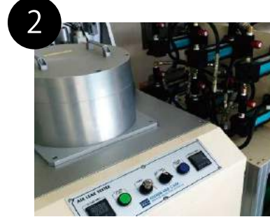
2 気密性テスト (Air Leak Test)
