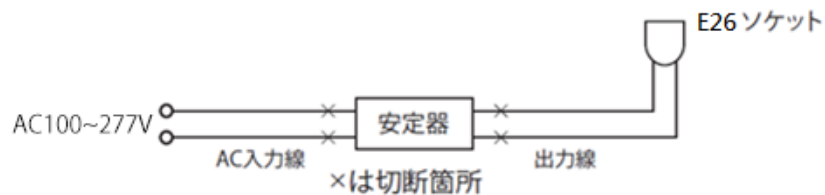
図①：現行の配線と切断箇所
