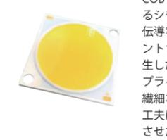
COBタイプLEDパッケージの第一人者であるシチズン電子社製を使用。発光素子を熱伝導率の高いアルミニウム基盤に直接マウントされていることにより、発光素子で発生した熱を効率よく逃がします。プライム・スターのDOME-Sシリーズは、繊細なLEDパッケージを熱から守る独自の工夫により、明るさと高い発光効率を両立させた製品です。
